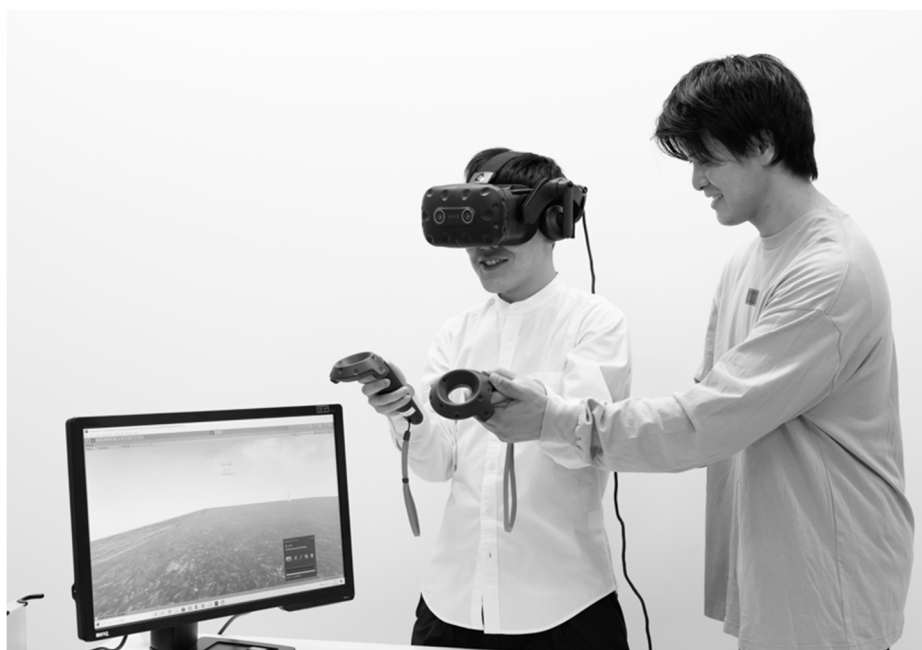
Figure 1 HMDを装着し、両手にコントローラをもって操作しながらVR映像を観察している様子。実験者は映像をディスプレイに同時出力させることで、観察者が何を見ているかを確認できる。HMDやコントローラの形状や特徴はメーカーや時代により大きく異なる。写真はHTC VIVE pro eye。
